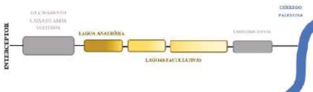
Figura 163 – Diagrama esquemático da ETE Paulistano II.
