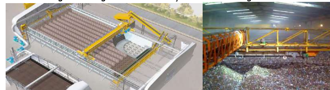
Figura 67: Digestão Aeróbia Forçada com Biossecagem
