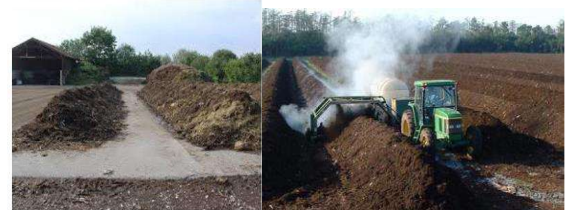
Figura 66: Tratamento Biológico Aeróbio (Leiras de Compostagem)
