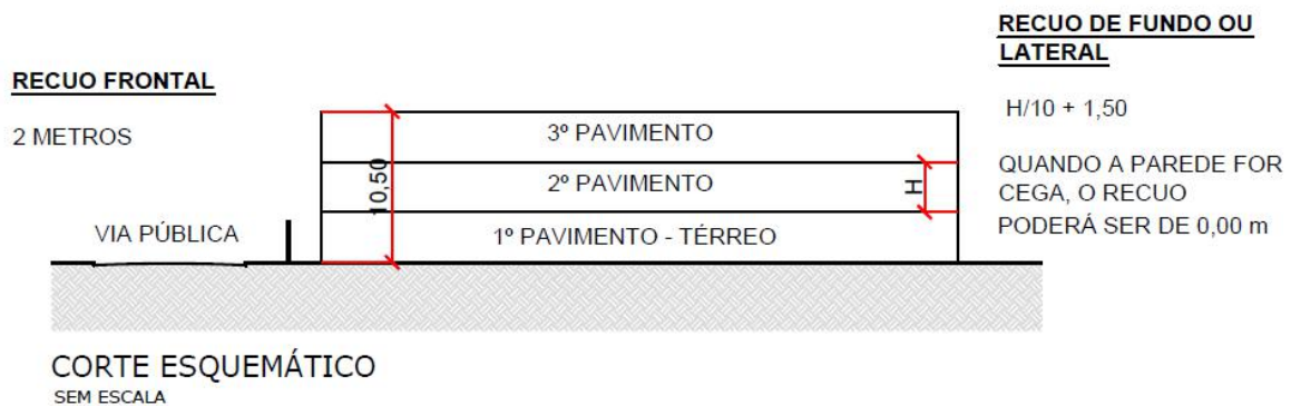
Figura 03 – Edifícios de 03 pavimentos
