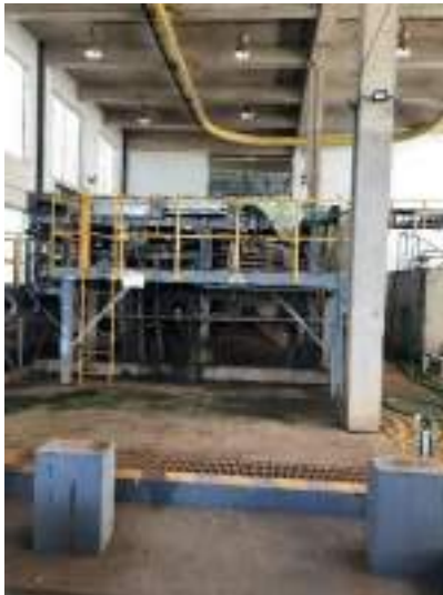
Figura 3.5.3(21) – Filtro prensa e secagem do lodo em pátio após passagem pelo filtro
